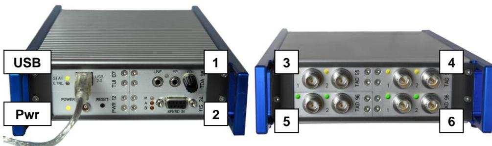
En la sección Ocupación de canal A/D aparecen solo módulos - Conversor A/D (ninguna tarjeta de número de revoluciones, Conversor A/D o similar). Cada uno de estos convertidores A/D posee dos canales:
