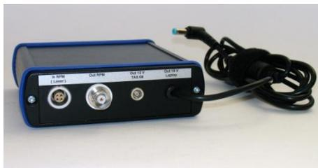
El sensor laser es conectado al Interfaz Power y de señal, conexión **en RPM (Laser)**. La conexión **Out RPM** se comunica con el canal de velocidad del TAS Box.
